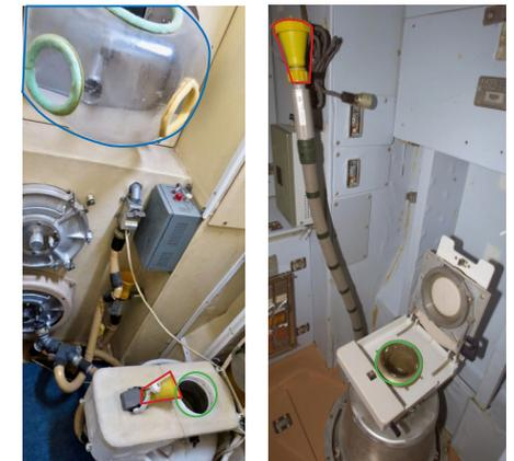
Fig.5a : Maquette des toilettes de la Station MIR. En rouge, embout du tube pour uriner, en vert, réceptacle fécal, en vert, boîte pour le lavage des mains.
