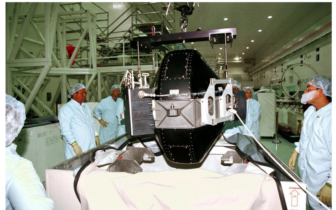
Fig.9 : Assemblage du CMG sur la poutre
