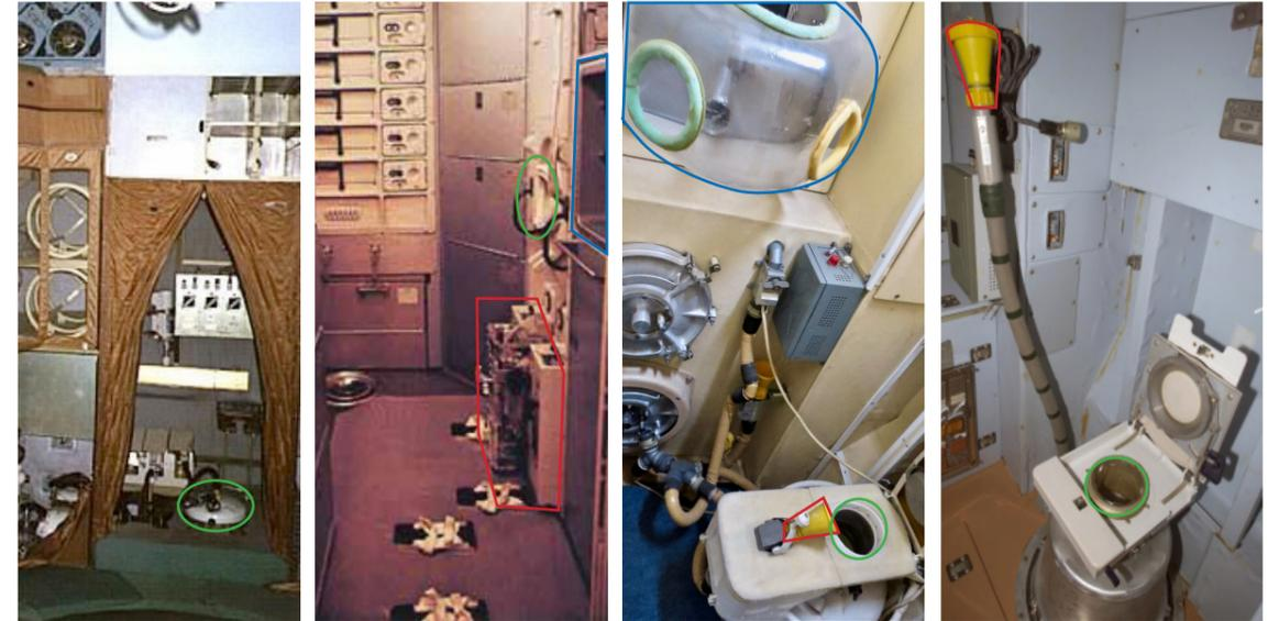
Fig.41a : Toilettes de la station Saliout, en vert, ouverture des toilettes.
