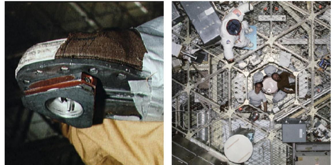
Fig.30a : Gauche, chaussures à crampons triangulaire venant se fixer sur le grillage de même géométrie de la station
