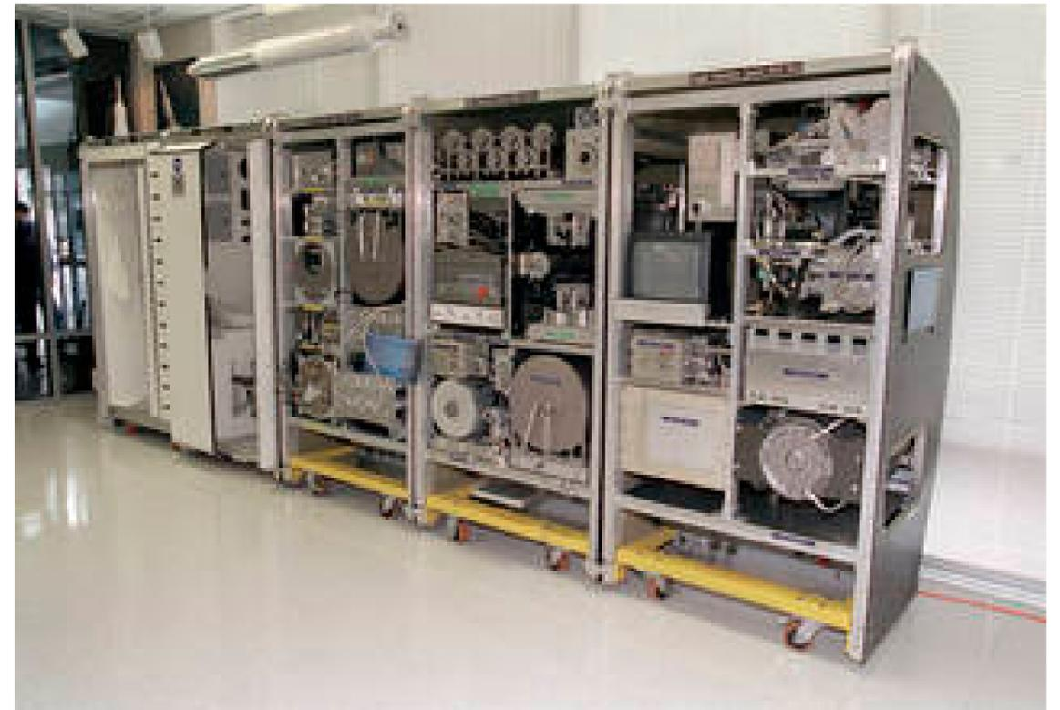
Fig.5 : Maquette de l'ECLSS, 2001. De gauche à droite, le support de douche, le support de gestion des déchets, les deux systèmes de récupération d'eau et le support du système de génération d'oxygène. (Source : NASA)
