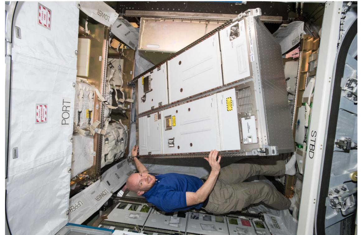
Fig.11 : Photo de l'astronaute Alexander Gerst à bord de l'ISS installant le système de recyclage de l'eau de l'ECLSS 1er octobre 2018.
